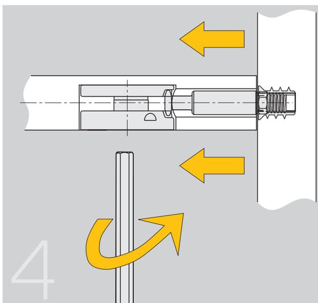
Beim Drehen des Exzenter wird der Bolzen bewegt, wodurch eine starke und effiziente Verbindung von Seitenwand und Platte erreicht wird.
