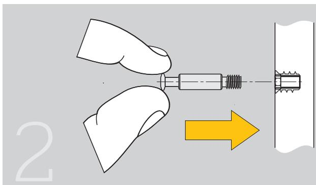
Muffe in die Seitenplatte einsetzen und Verbindungsbolzen in die Muffe.
