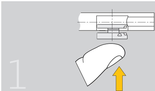
Den Spiralexzenter von Hand in das Loch in der Platte einsetzen.
