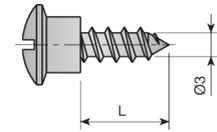
Holzgewindeschraube für Ø4mm Bohrung.
