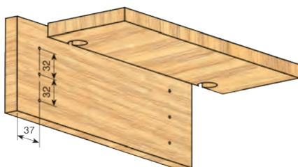
■ Verbindungsbeschläge **CLOCK-6 Ø20**
