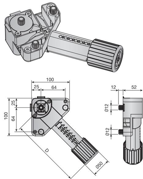
Beutel mit montierten Sockelhöheverstellern, 1 Zapfen Ø12, Dübel- oder Schraubmontage.
