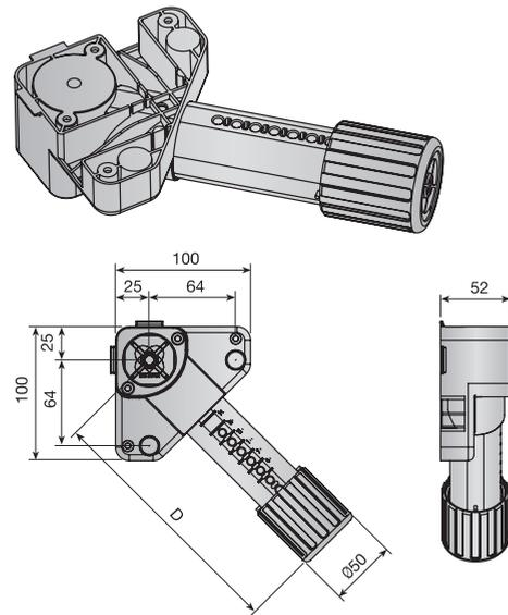
Beutel mit montierten Sockelhöheverstellern, Dübel- oder Schraubmontage.
