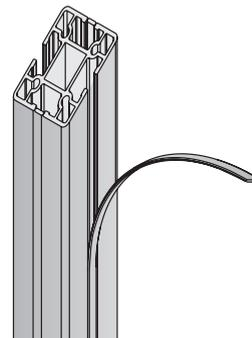
Zum Freilegen der Rinne genügt es, den Aluminiumschutzstreifen zu lösen.
