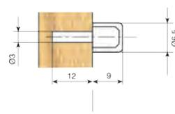
Halterung für Einlegeböden für Glasböden Ø5.
