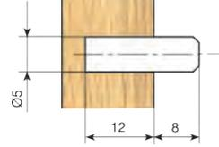
Halterung für einlegeböden mit eingefügter Holzschraube.
