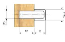
Halterung für Einlegeböden flach Ø3.
