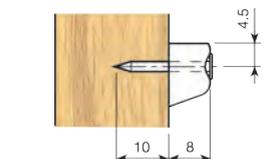
Halterung für Einlegeböden für Glasböden Ø3.
