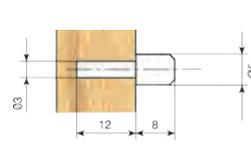
Halterung für Einlegeböden zylindrisch Ø5.
