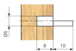
Halterung für Einlegeböden zylindrisch Ø3.
