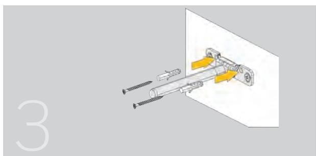
Mit den restlichen 2 Dübeln und Schrauben wird der Träger in der endgültigen Position befestigt und kann sich nicht mehr aus der Justierung bewegen.
