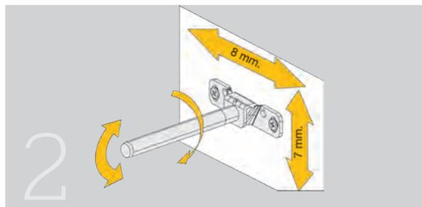
Die ovalen Schraublöcher ermöglichen eine genaue Höheneinstellung. Die Seitenverstellung wird durch die Verschiebung der Stange auf dem Träger erreicht. Durch die Drehung der Trägerstange wird der Neigungswinkel eingestellt.
