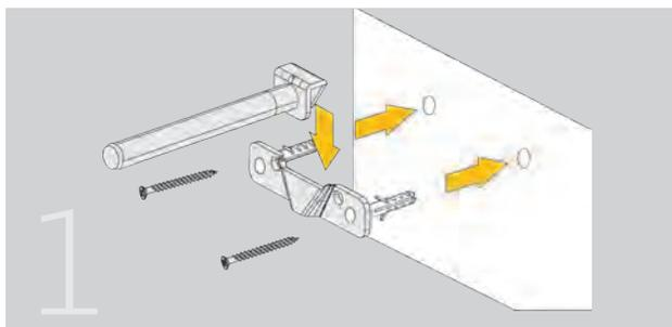
Die Halterung wird mit den mitgelieferten Dübeln und Schrauben an der Wand befestigt. Dann wird die Trägerstange aufgesteckt.
