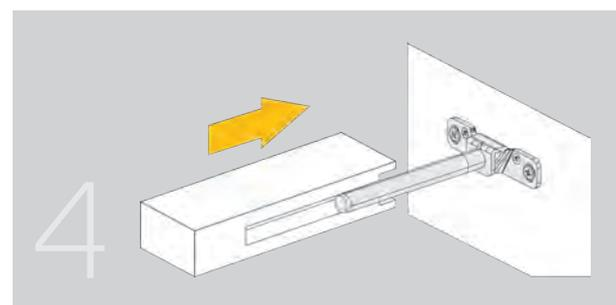
Zuletzt wird der Boden aufgesteckt. Dieses kann zu einer weiteren Justierung wieder abgenommen werden.
