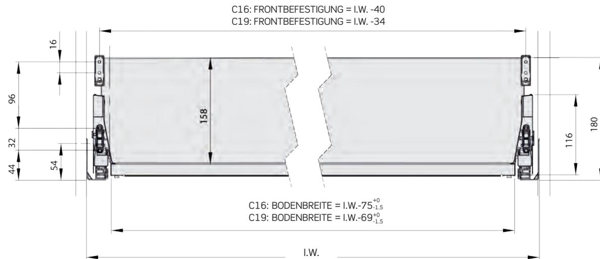
Bohrbild für den oberen und unteren Frontadapter für den Schubkasten H172
