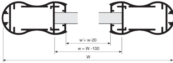
Bearbeitungslängen des Griffleistenprofils
