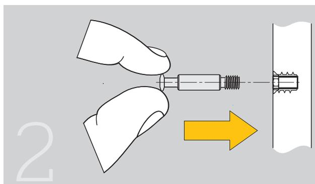
Introduire l'écrou dans le logement du côté puis visser le goujon sur l'écrou.
