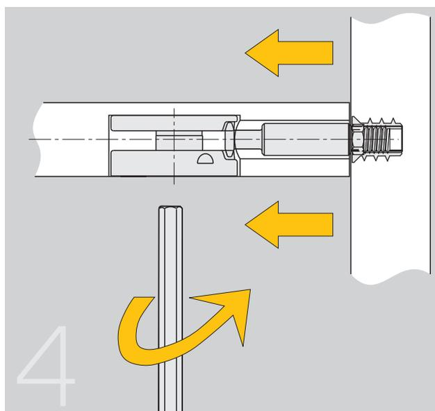
En tournant l'excentrique, le goujon se déplace vers celle-ci, unissant le côté et l'assemblage. La fixation ainsi obtenue est solide et efficace.
