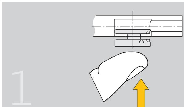
Introduire manuellement l'assemblage **Excentrique à spirale** dans la partie usinée de l'étagère ou du panneau.
