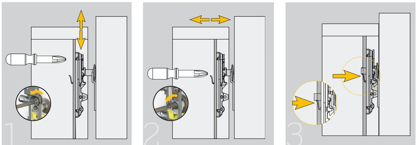
Montage : régler en hauteur jusqu'à la position souhaitée, ensuite régler en profondeur et pousser l'anti-basculement pour le clipser
