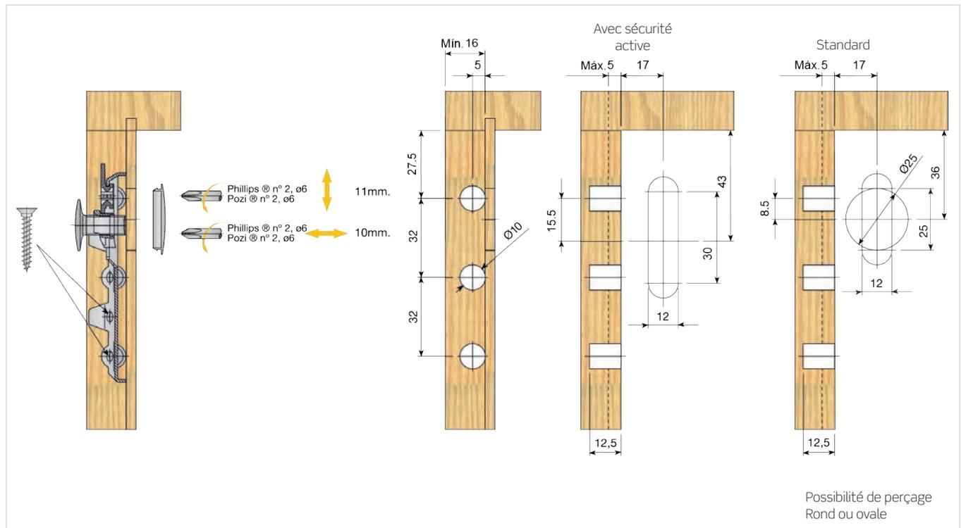
■ TRASER-8: Montage à frapper avec appui supérieur
