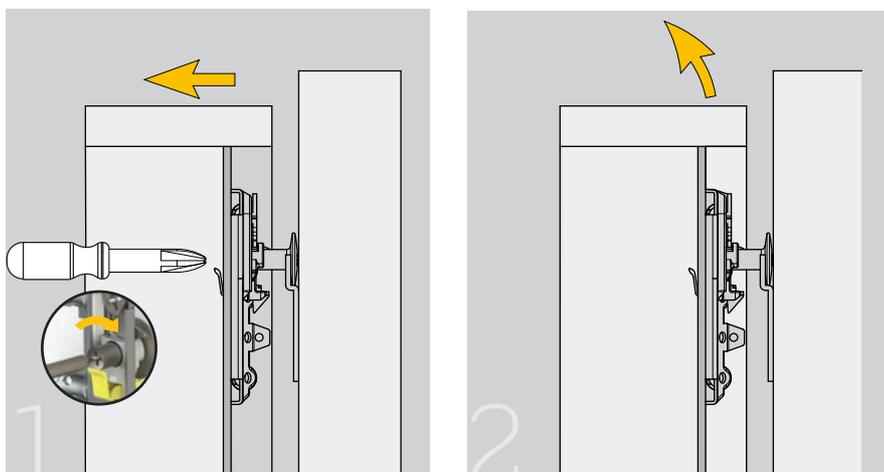
Démontage : régler au maximum en profondeur pour déclipser l'anti-basculement et démonter le caisson.
